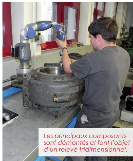
*Les principaux composants sont démontés et font l'objet d'un relevé tridimensionnel.*
