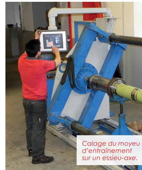
*Calage du moyeu d'entraînement sur un essieu-axe.*
