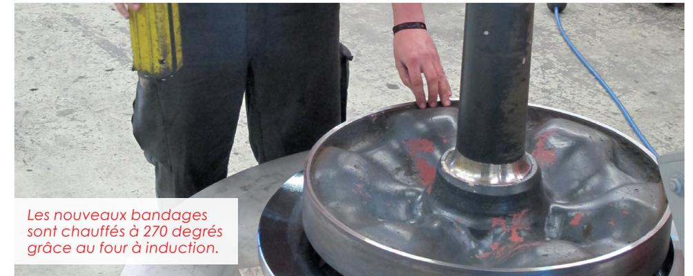
*Les nouveaux bandages sont chauffés à 270 degrés grâce au four à induction.*
