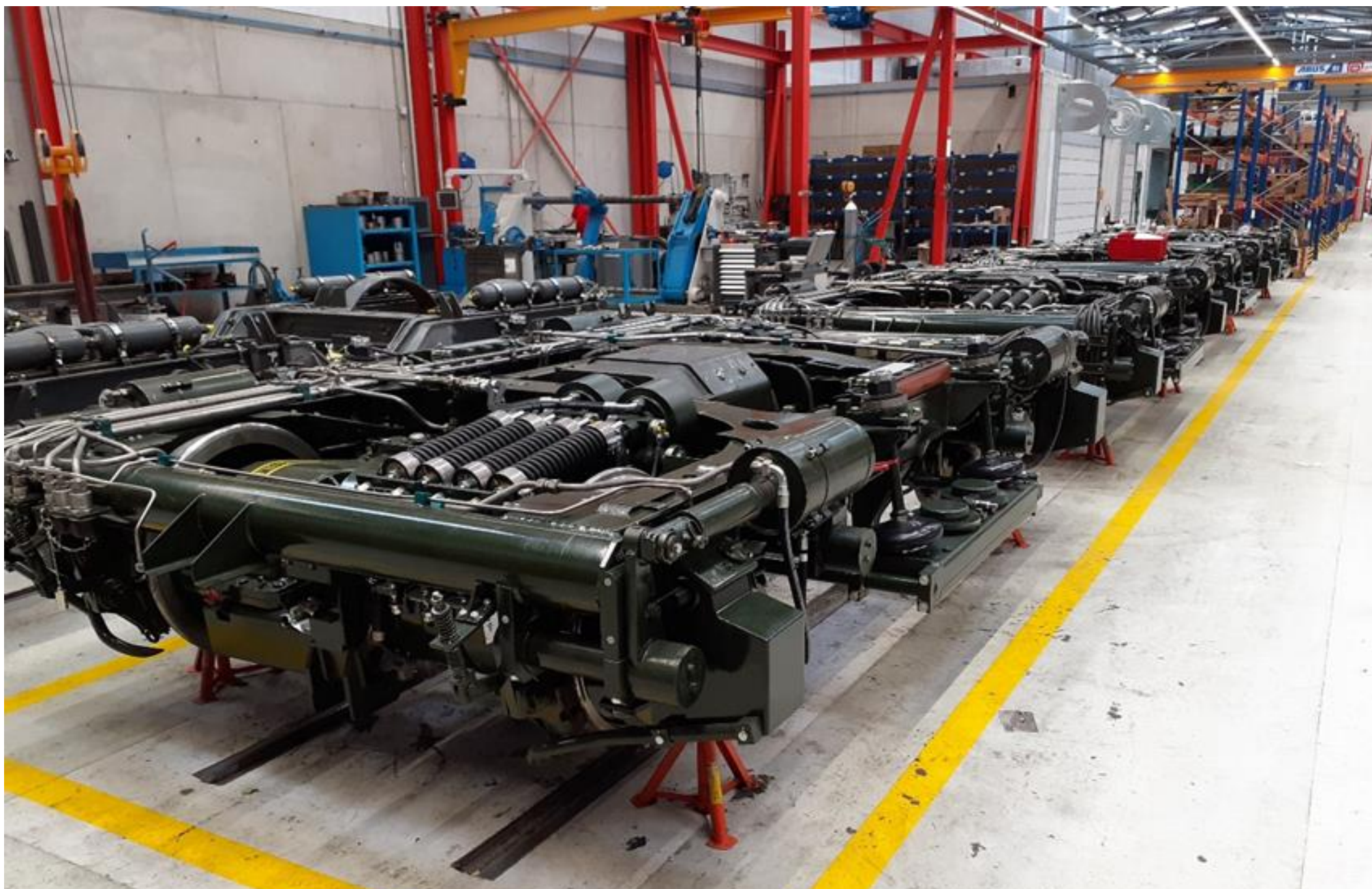
Grande inspection d'un lot de 4 bogies crémaillère à voie normale MCL80.
