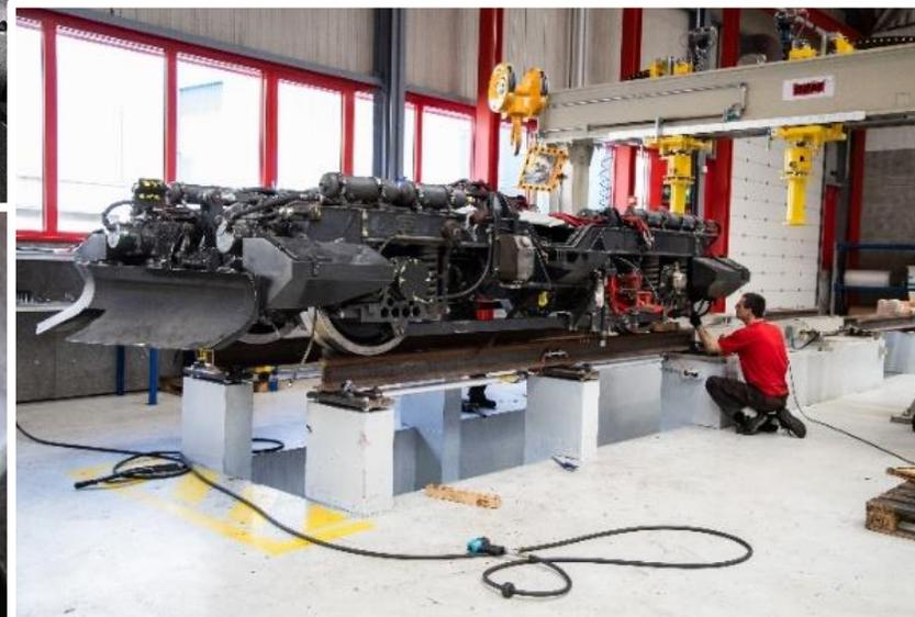
Réassemblage du bogie avec ses composants révisés.
