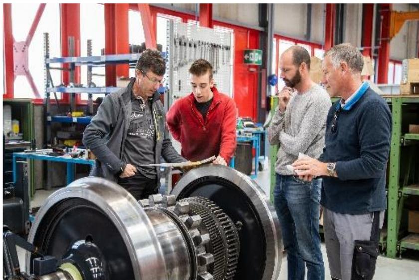
Stand de montage des essieux montés – contrôle des dimensions.
